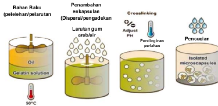
Gambar 5.5 Skema proses umum pembuatan mikro kapsul koacervasi kompleks dengan menggunakan gelatin dan gum arab.
